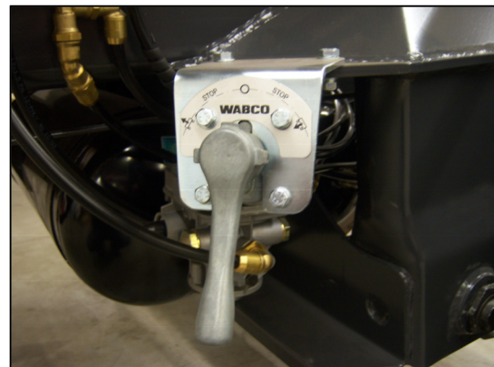
Abb.9: Drehschieberventil in Fahrstellung
